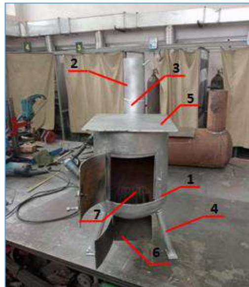
Рис.10. Будова грубки - «буржуйки»
