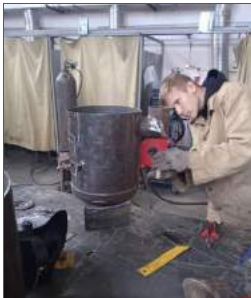
Рис.8. Перевірка розташування відводу відносно корпусу магнітним кутником
